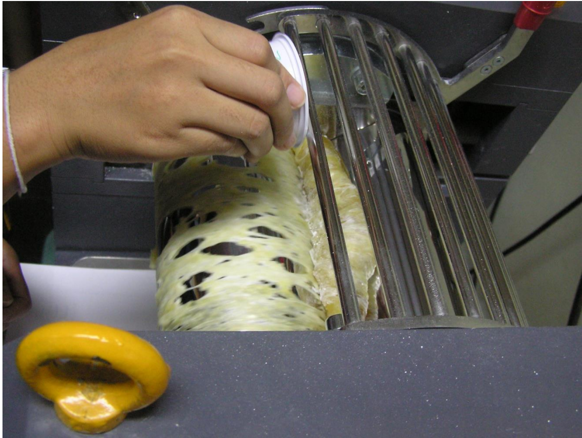
การเติมสารเคมีลงบน Bank
